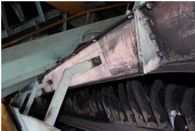
③コンベヤベルト部 ※全長43.5mのうち約8mを焼損
