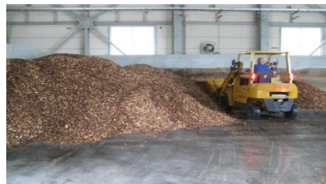
攪拌用重機及び攪拌状況
