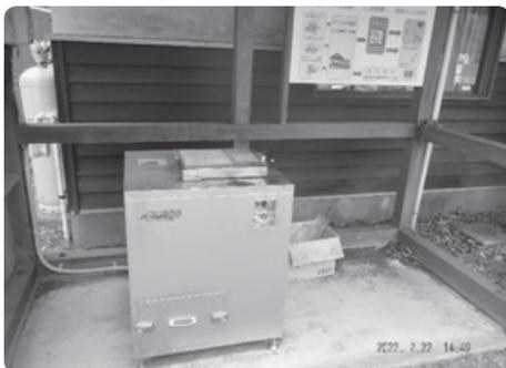
衛生組合の補助制度を利用して導入した業務用生ごみ処理機
